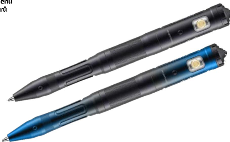
Fenix T6 je kombinací taktického pera a svítilny, která poskytuje světelný výkon až 80 lumenů a dosvit až 18 metrů. Tělo je vyrobené ze slitiny hliníku A6061-T6 a jeho povrch je opatřen tvrdou anodizačním typu HA-III s vysokou odolností proti poškrábání. Svítilnu napájí zabudovaný Li-pol akumulátor s kapacitou 100 mAh, který se dobíjí přes moderní USB-C konektor. Celkově
