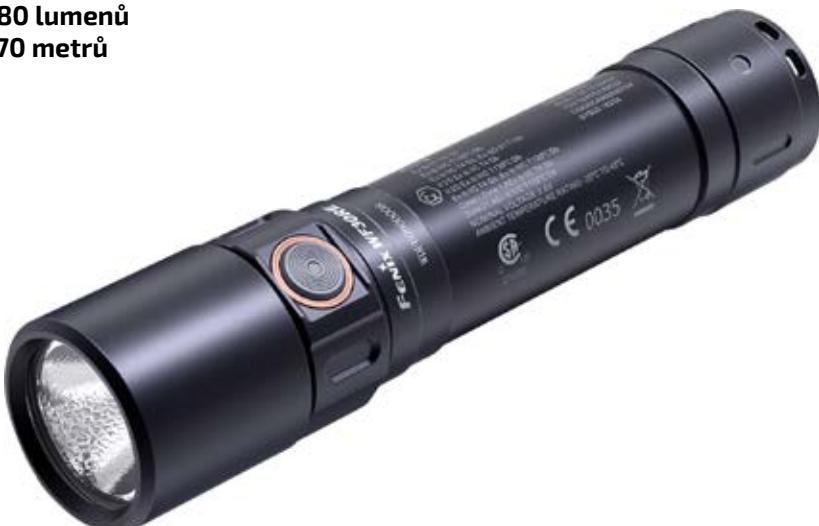
Profesionální nabíjecí svítilna Fenix WF30RE je opatřena certifikací ATEX/IECEx pro použití v zónách 1-2 výbušných plynů a v zónách 21-22 výbušného prachu. Svítilna je napájená speciálně upraveným Li-ion akumulátorem ARB-L21-2600Ex s kapacitou 2600 mAh a poskytuje světelný tok až 280 lumenů s dosvitem 170 metrů. Akumulátor se dobíjí přímo ve svítilně za pomoci speciální nabíječky s bezpečnostními obvodami. Tělo svítilny
