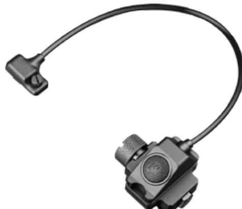
Taktický kabelový spínač AER-06S pro svítilnu Fenix GL19R pro použití se svítilnou montovanou na dlouhé zbrani. Kabel se se svítilnou propojí prostřednictvím USB-C portu. Na druhém konci kabelu je umístěné bezhlubné tlačítko. Spínač lze díky přiloženému příslušenství umístit na zbraňovou lištu Picatinny MIL-STD-1913 i rozhraní M-LOK.
