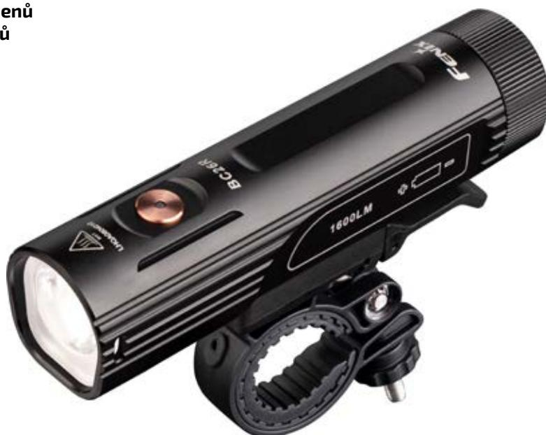
Nabíjecí svítilna na kolo Fenix BC26R přináší světelný tok až 1600 lumenů s dosvitem až 169 metrů. Je napájeno akumulátorem typu 21700 s kapacitou 5000 mAh, který se nabíjí USB-C konektorem přímo ve svítilně. Světelným zdrojem je moderní dioda Luminus SST-40. Speciálně tvarovaný světelný
