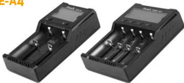
Univerzální nabíječky dokážou nabíjet Li-ion i NiMH akumulátory všech běžných velikostí s délkou 32 – 75 milimetrů. Nabíjecí kanály jsou zcela nezávislé, lze tedy nabíjet jednu až dvě baterie (model ARE-A2), nebo jednu až čtyři baterie (model ARE-A4) s různou chemií, velikostí, kapacitou i stavem nabití. Informace o průběhu nabíjení jsou zobrazovány na přehledném LCD.
