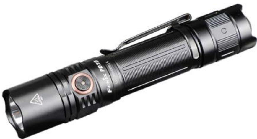
Nejnovější generace svítilny Fenix PD35 přináší světelný tok až 1700 lumenů a dlouhou výdrž až 230 hodin v nejnižším režimu. Výborného dosvitu až 357 metrů bylo dosaženo použitím nejnovější LED Luminus SFT-40. Svítilnu je možné napájet ze dvou CR123A baterií nebo jednoho Li-ion 18650 akumulátoru (akumu-
