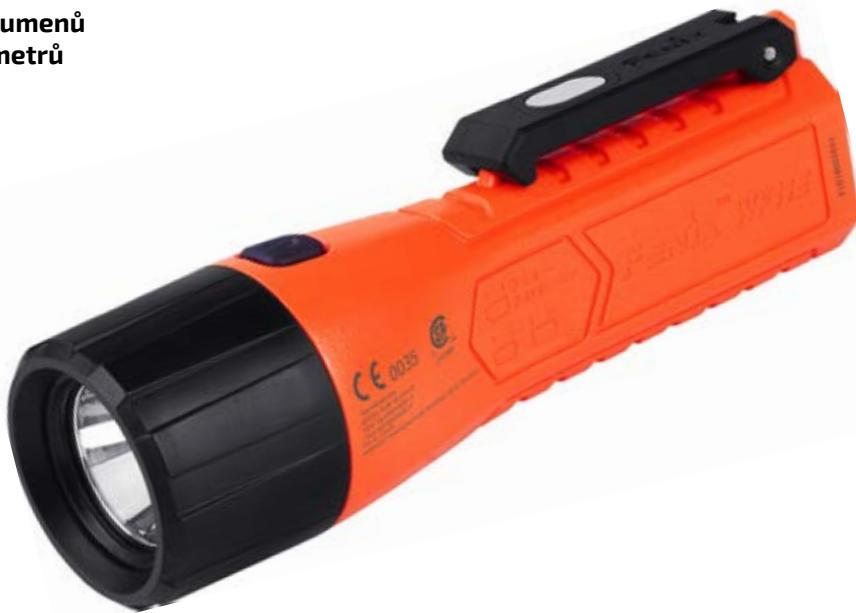
Profesionální svítilna Fenix WF11E je opatřena certifikací ATEX/IEC pro použití v zónách 0-2 výbušných plynů a v zónách 20-22 výbušného prachu. Je napájená třemi tužkovými (AA) bateriemi a poskytuje světelný tok až 200 lumenů. Tělo svítilny je vyrobeno z antistatického plastu (polykarbonát RTP399 x 133887) s vysokou odolností a nárazuvzdorností. Navíc je tento model
